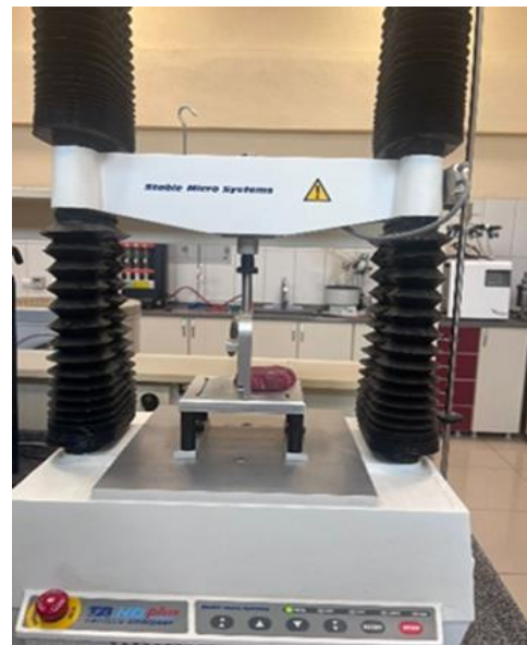
Fotoğraf 2. Tekstür Profil Analiz ve Warner-Bratzler Shear Force Analiz Cihazı
