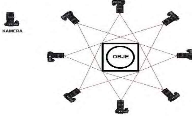
Şekil 4. Fotogrametrik Resim Çekim Tekniği
