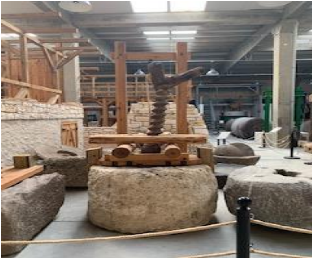
Fotoğraf 6. İnsan Gücü ile alışan Roma Dönemi Zeytinyağı İşliğı
