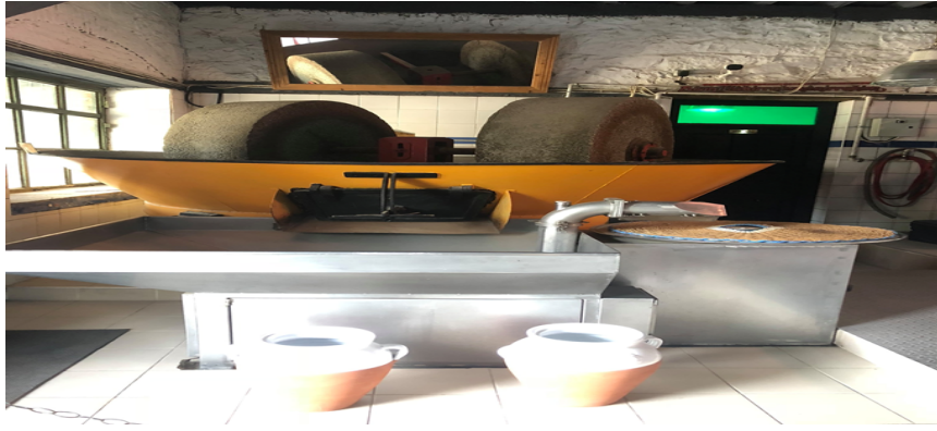
Resim 2: Zeytin hamuru taşların her biri 1,5 ton ağırlığında bulunan taş değirmen.
